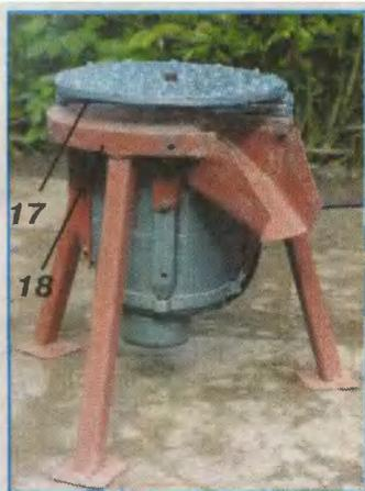
Фото 2 Основа лушцилки без цилиндра (бункера)
